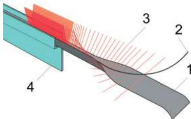
Die Streifenbürste besteht aus einem U-förmigen Stahlband (1), meistens aus elektroverzinktem od. rostfreiem Stahl, in das ein Haltedraht (2) aus dem gleichen Werkstoff eingelassen ist. Das Besatzmaterial (3) wird zwischen diesen beiden Elementen eingefügt. Durch Quetschverbindung der Teile erhält man die Streifenbürste. Zur leichteren Befestigung wird die Bürste in einen Halter bzw. eine Halteschiene (4) geschoben.
